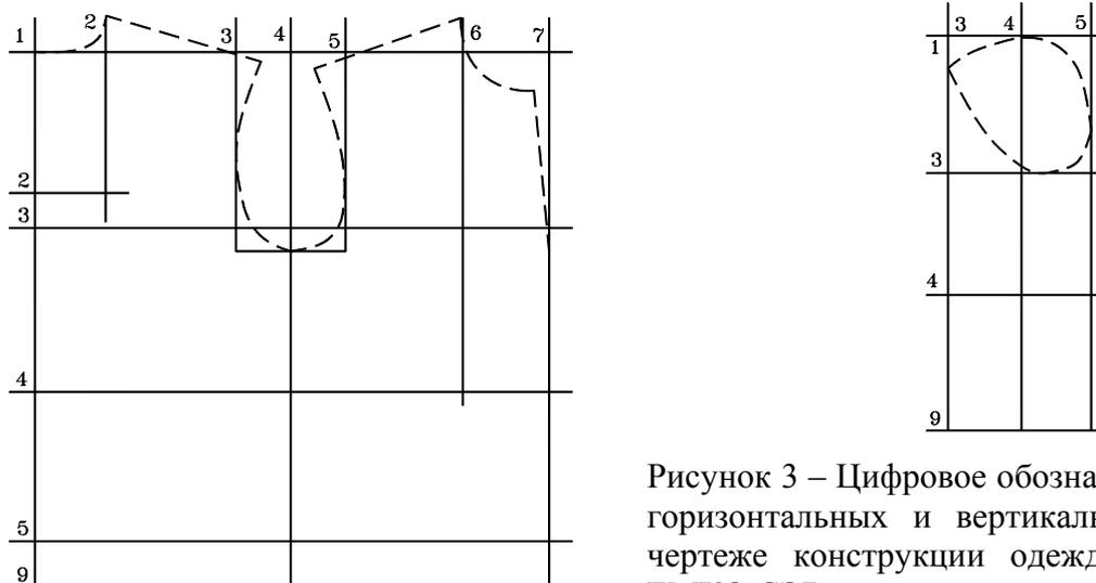
Рисунок 3 – Цифровое обозначение исходных горизонтальных и вертикальных линий на чертеже конструкции одежды, принятое в ЕМКО СЭВ
