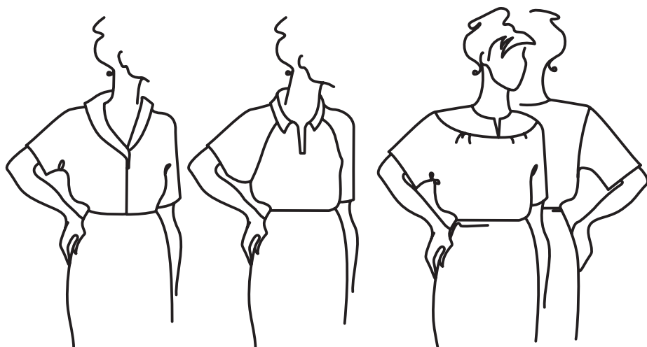
Рис. 1.14. Варианты формы плечевой области в изделиях с рукавами покровов: цельнокроеного, реглан, комбинированного
