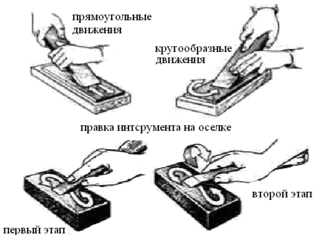
Рисунок 15.7 – Этапы заточки инструмента
