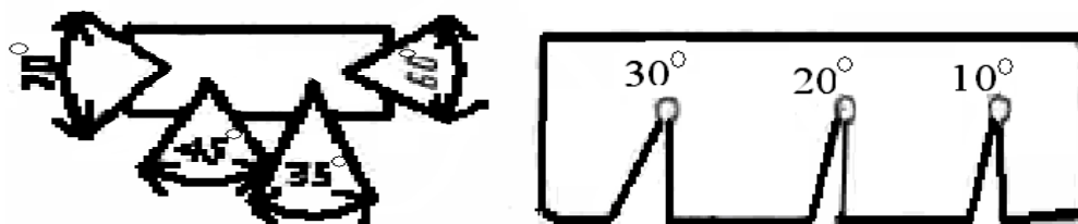
Рисунок 15.1 – Шаблоны для проверки угла заточки
