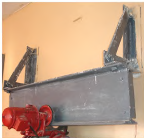
Рисунок 9.1 – Лабораторный стенд и расчетная схема монорельса
