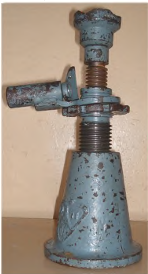
1 – корпус; 2 – полый винт; 3 – гайка; 4 – сплошной винт; 5 – головка; 6 – рукоятка с трещеткой
