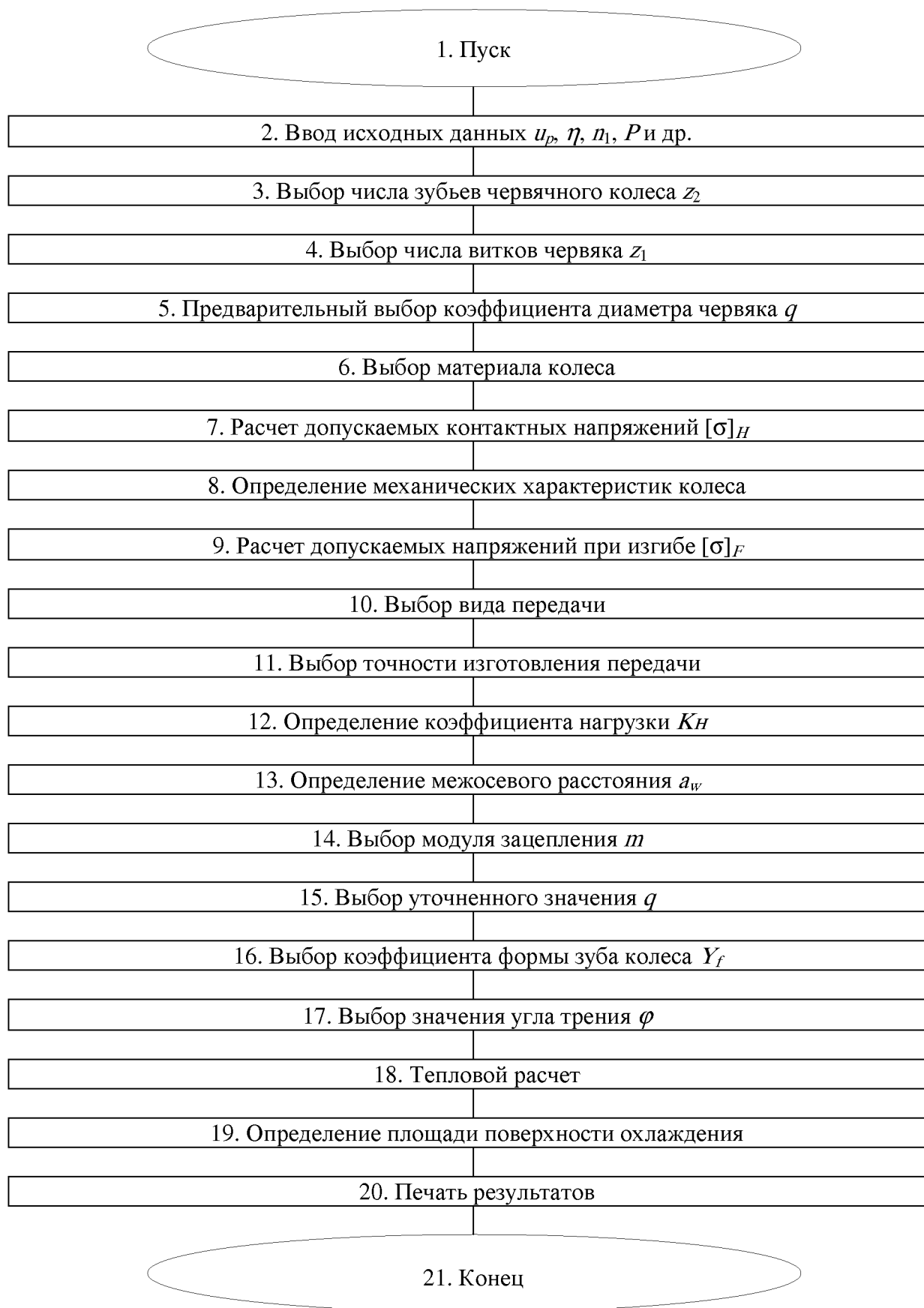
Рисунок 2.4 – Схема алгоритма расчета червячной передачи
