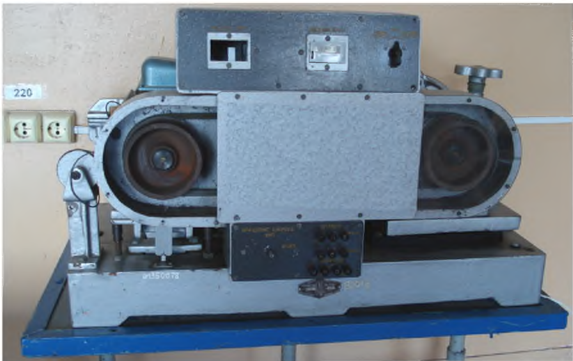
Рисунок 4.2 – Установка по определению основных параметров клиноременной передачи
