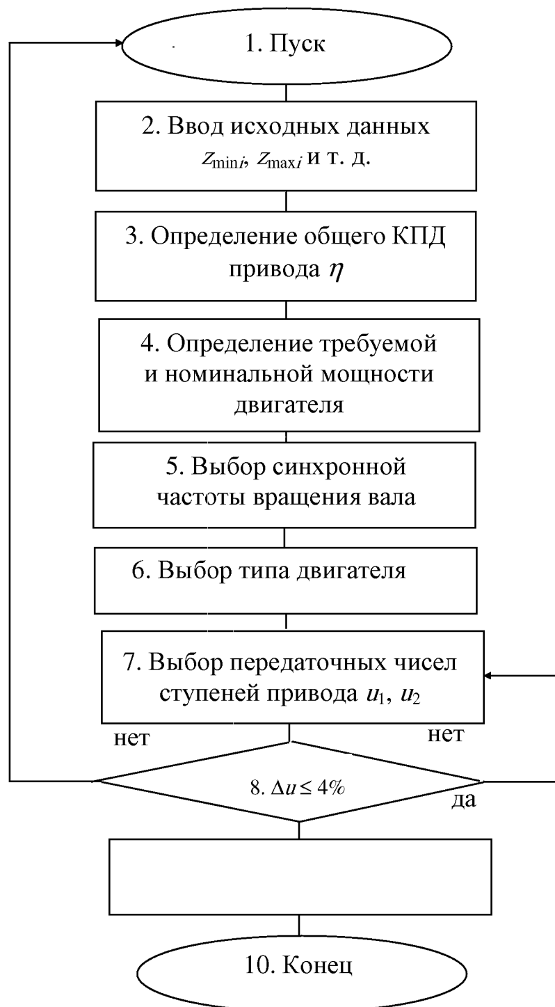
Рисунок 1.1 – Схема алгоритма расчета цилиндрических зубчатых передач
