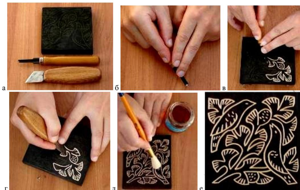
а – інструменти (нож-косяк, угольова стамеска) і заготовка з деревини, б – правильне положення рук при різьбі угольовою стамескою, виключаюче срыв різця, в – різьба угольовою стамескою, г – різьба ножом-косяком, д – нанесення кистью лака на поверхню заготовки з вирізаним рисунком (закріплення резного рисунка), е – готове изделие
