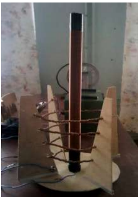
Рисунок 1 – Прибор для демонстрации беспроводной передачи энергии
